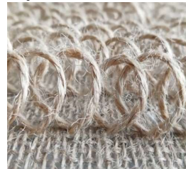
Abbildung 4: Jutegewebe als Trägermaterial mit Jute-Polgarn
