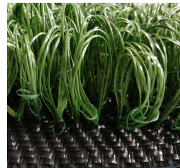
Abbildung 2: Bewehrungsgewebe mit Polyethylen-Multifilament-Polgarn
