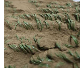
Abbildung 5: Mit Lehm Boden eingedecktes getuftetes Geotextil
