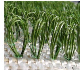
Abbildung 3: Küstenschutzgewebe mit Polyethylen-Multifilament-Polgarn,
